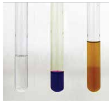
A B C Etanolu (A) smo dodali kislno raztopino KMnO_4 (B). Pri reakciji vijolična barva izgine, pojavi se rjav manganov dioksid MnO_2 (C).
