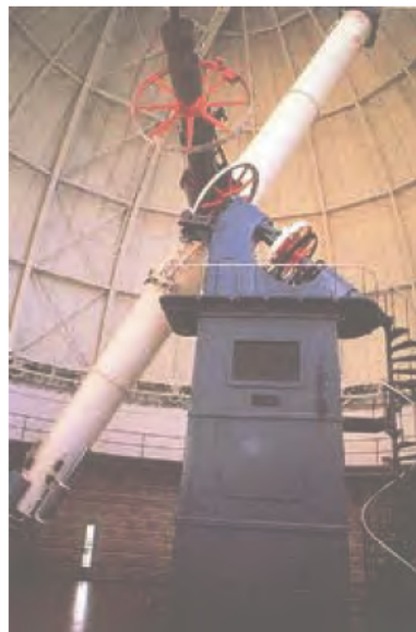
Največji daljnogled z lečami (refraktor) na svetu je postavljen v zvezdarni Yerkes v ZDA (20. stol.). Premer vhodne zenice, tj. leče, skozi katero prihaja svetloba, je 100 cm.
